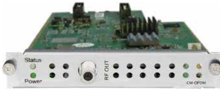
CM2-OFDM-R01/R01A: OFDM Modulation Module
